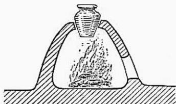
Рис. 50. Разрез печи с отверстием в верхней части.
