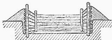
Рис. 40. Столбовая конструкция стен полуземляничного жилища.
